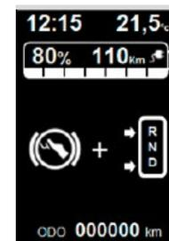
Appuyer sur la pédale de frein et sélectionner le mode de conduite sur la console centrale:
