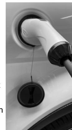
Brancher en premier le cordon sur la prise électrique domestique 220 V, puis sur le véhicule.
