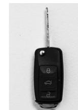
Fermeture impulsion cadenas fermé. L'impulsion entraîne un clignotement long des feux de direction.
