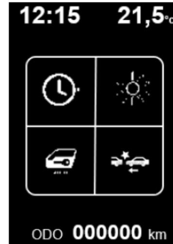
1. Un appui long sur le bouton gauche permet de rentrer dans les réglages.
