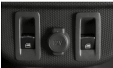
L'ouverture des vitres s'effectue avec le moteur tournant ou avec le 2<sup>ème</sup> cran du contact.
