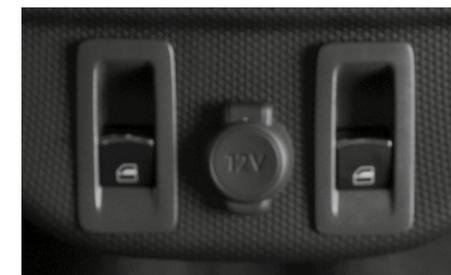
L'utilisation de la prise 12V sur le tableau de bord permet de brancher ou recharger uniquement des appareils prévus de fonctionner avec une tension de 12 V (sinon risque de dommages sur circuit électrique du véhicule ou de l'appareil branché).
